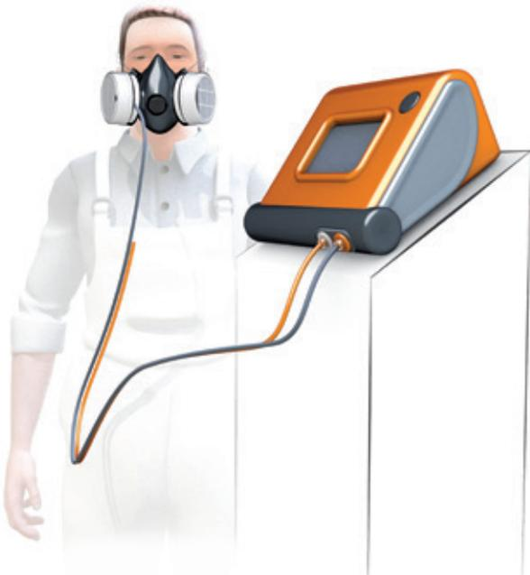
(Essai d'ajustement quantitatif
