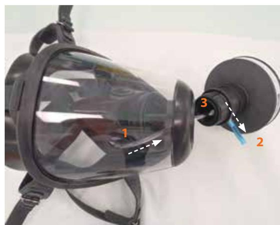
Figure 2. Adaptation d'un masque complet pour la réalisation d'un essai d'ajustement quantitatif par comptage de particules.
