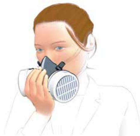
Figure 3. Contrôle d'étanchéité à pression positive
